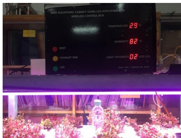
Hình 7. Mạch điện tử điều khiển và hiển thị các giá trị đo từ môi trường của tủ (từ trên phải xuống): nhiệt độ, độ ẩm và độ rọi của môi trường trồng rau.
